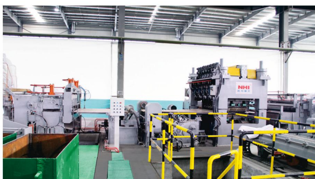
铸轧生产线，共22条 产能：25万吨 厚度：6.0~8.0mm 宽度：700~1850mm
