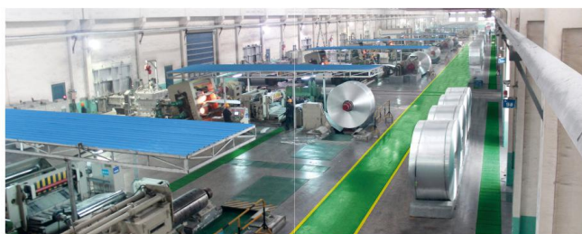
铸轧生产线，共22条 产能：25万吨 厚度：6.0~8.0mm 宽度：700~1850mm
