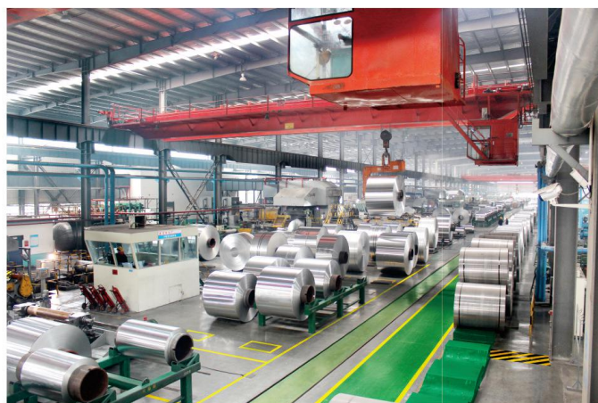
冷轧生产线，10台冷轧机 产能：35万吨 厚度：0.03~3.0mm 宽度：150~1900mm
