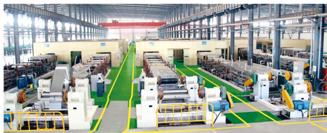
涂层生产线，共9条 产能：10万吨 厚度：0.08~0.2mm 宽度：150~1400mm
