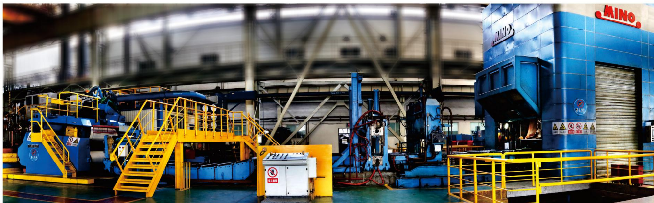
哈兹列特（连铸连轧）生产线，共1条 产能：25万吨 厚度：2.0~7.0mm 宽度：最宽1935mm
